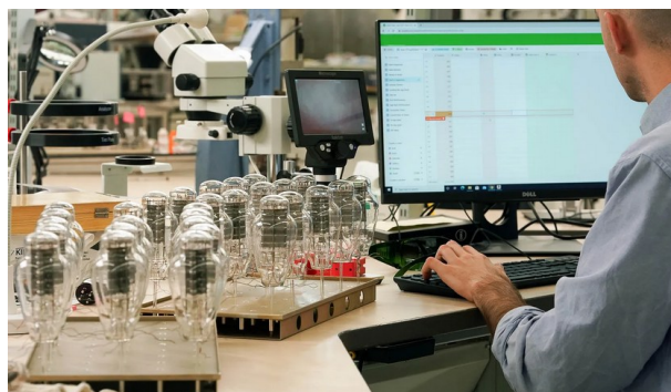
Inspección de tubos de vacío recién sellados.
