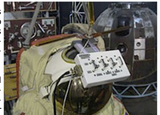
Panel de control para SuitSat-1 en el exterior del traje espacial permitió a la tripulación activar SuitSat-1
